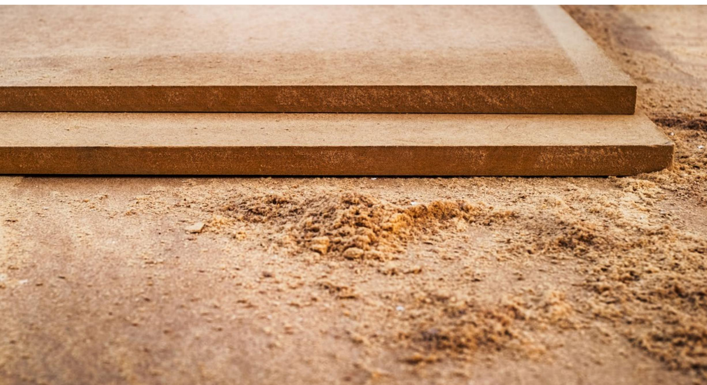
Panneaux de fibres de bois : Matériau en plaque d'une épaisseur égale ou supérieure à 1,5 mm obtenu à partir de fibres lignocellulosiques avec application de chaleur et/ou de pression.
